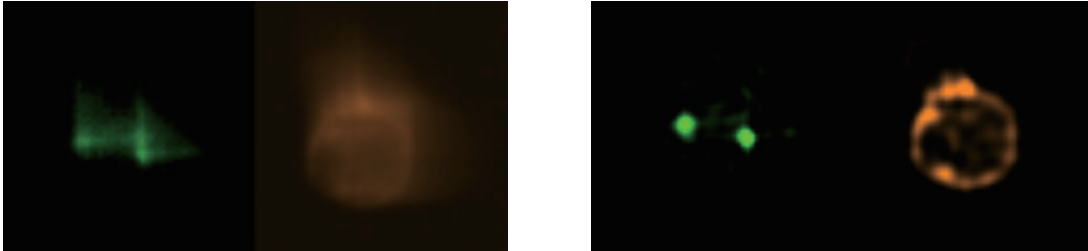
数据获取时的细胞图像:左图 — 使用EDF模块, 右图 — 未使用EDF模块
