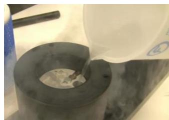
放冷冻样品铜网到冷冻传输架之前，需在传输架的杜瓦瓶中和传输台中加满液氮，提前冷却冷冻传输架（连上控温仪器，将温度稳定在-170度左右）
