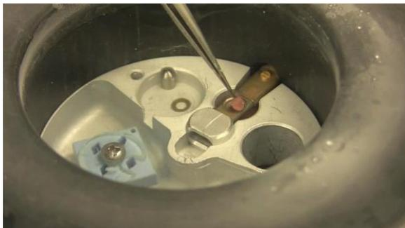
用提前冷却好的镊子仔细小心的将样品铜网从铜网盒里面取出放在冷冻传输架上。
