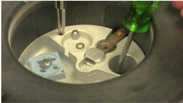
提前在液氮中冷却好任何会接触到冷冻样品铜网的镊子、加样杆等。
