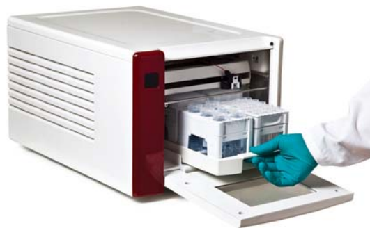
图 8. 灵活组分收集器 F9-C 可容纳 3 至 50 mL 各种试管以及 24、48 和 96 深孔板的管架。
