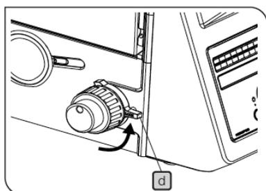
用粗调旋对标本大致聚焦后，向箭头方法旋转聚焦限位杆 **d** 进行锁定。此后，粗调的上限即限制在限位杆锁定位置。
