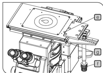
1. 用随显微镜提供的六角螺丝刀取出垂直方向上的移动范围限位螺钉 **e**。
