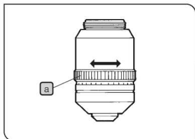
◎ 如果盖玻片或器皿的厚度与带校正环的物镜的厚度刻度不匹配，物镜就不能发挥其性能。如果使用了配备有校正环的物镜，进行以下要求的调节。
