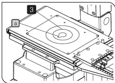
1. 将载物台安装孔与机架上的螺纹孔对齐，在显微镜上轻轻放置好载物台。
