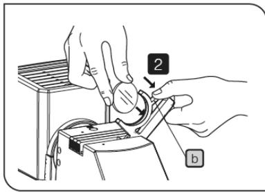
2. 一边握住滤色镜架的安装拉杆 **b**，一边插入滤色镜。
