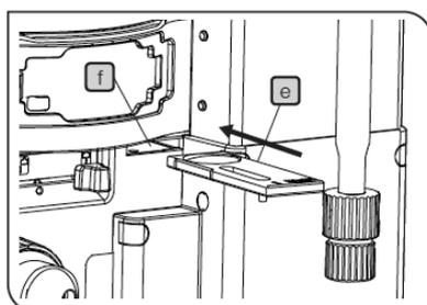
IXE-FDICT 是配备了检偏镜的镜组。它安装在镜组盒里，在透射微分干涉观察过程中安装在光路里。
