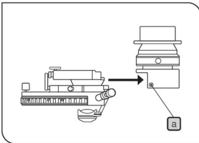
1. 使用六角螺丝刀，松开 IX-ADUCD UCD 适配器上的两个固定螺钉 **a**。
