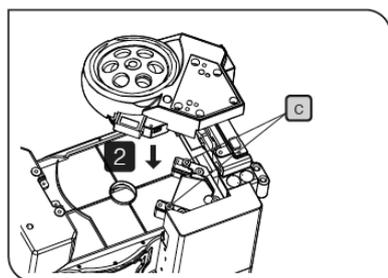
2. 将物镜转盘缓慢插入显微镜上端的定位插脚 **c** 中（两个位置）。
