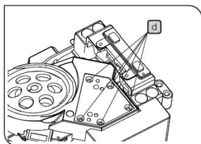
3. 用随显微镜提供的六角扳手拧紧物镜转盘固定螺钉 **d**（5个位置）。
