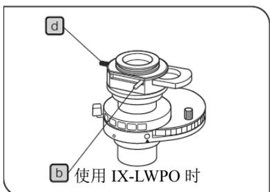
1. 旋转用于 BF(明场)光路的转盘(光路中没有安装光学元件)。
