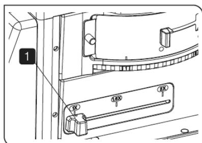
根据物镜放大倍率，使用编码中间放大倍率变换器 IX3-CAS 在以下三个等级中切换观察放大倍率。
