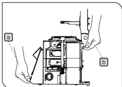
6. 移动显微镜时，请事先从显微镜上取出可能会掉落的部件，包括标本，然后握住底座（显微镜前边缘）**a**，并抓住照明柱下方的部件**b**，小心搬运显微镜机架。
