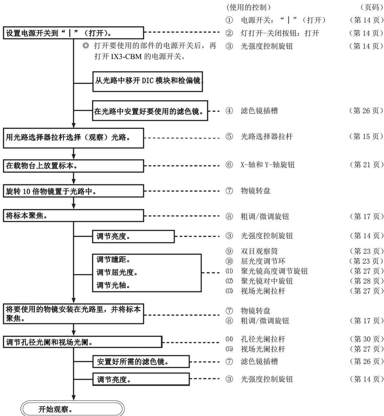
◎ 关闭电源时，请先关闭 IX3-CBM 的电源开关，然后再关闭其它部件的电源开关。
