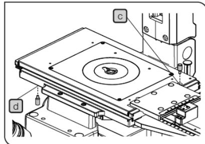
如果移动控制旋钮安装在了 **c** 的孔里，Y-轴的移动会被卡住。如果安装在了 **d** 的孔里（载物台的背侧），X-轴的移动会被卡住。
