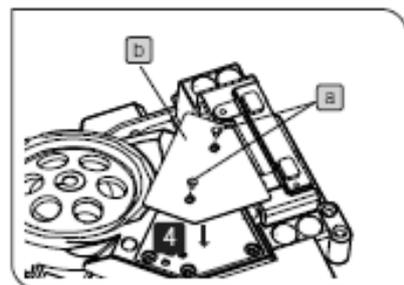
4. 将物镜转盘盖 **b** 放在物镜转盘上方，并用十字螺丝刀拧紧转盘盖固定螺钉 **a**（两个位置）。
