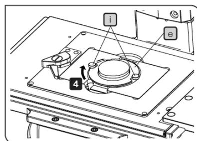
2. 在 IX-HO35D **g** 的中心设置固定架 **e**，使其位置与架固定旋钮 **i** 吻合。
