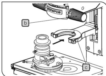
1. 旋转聚光镜高度调节旋钮 **b**，抬起聚光镜到上限位置。
