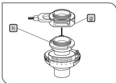
◎ 此起偏镜设计用于 DIC 观察或简化偏光观察时安装在 IX2-LWUCD 上。
