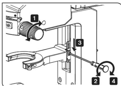
**注意** 用力旋转聚光镜高度调节旋钮，超过了聚光镜高度调节区域可能会导致显微镜损坏。旋转时要格外小心。
