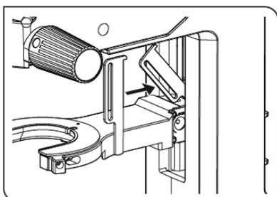
**注意** 如果聚光镜安装臂放在低位时安装了聚光镜重新聚焦限位器，可能无法安装聚光镜。安装聚光镜重新聚焦限位器以前务必抬起聚光镜安装臂。
