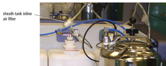
图 6-16 鞘液桶上的气路过滤器
