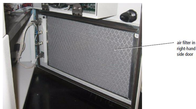
图 6-15 更换空气过滤网
