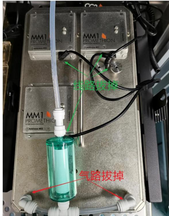
备注：拔除气路的时候，如下图，右手食指和中指卡住气管接头的卡扣，往上提。
